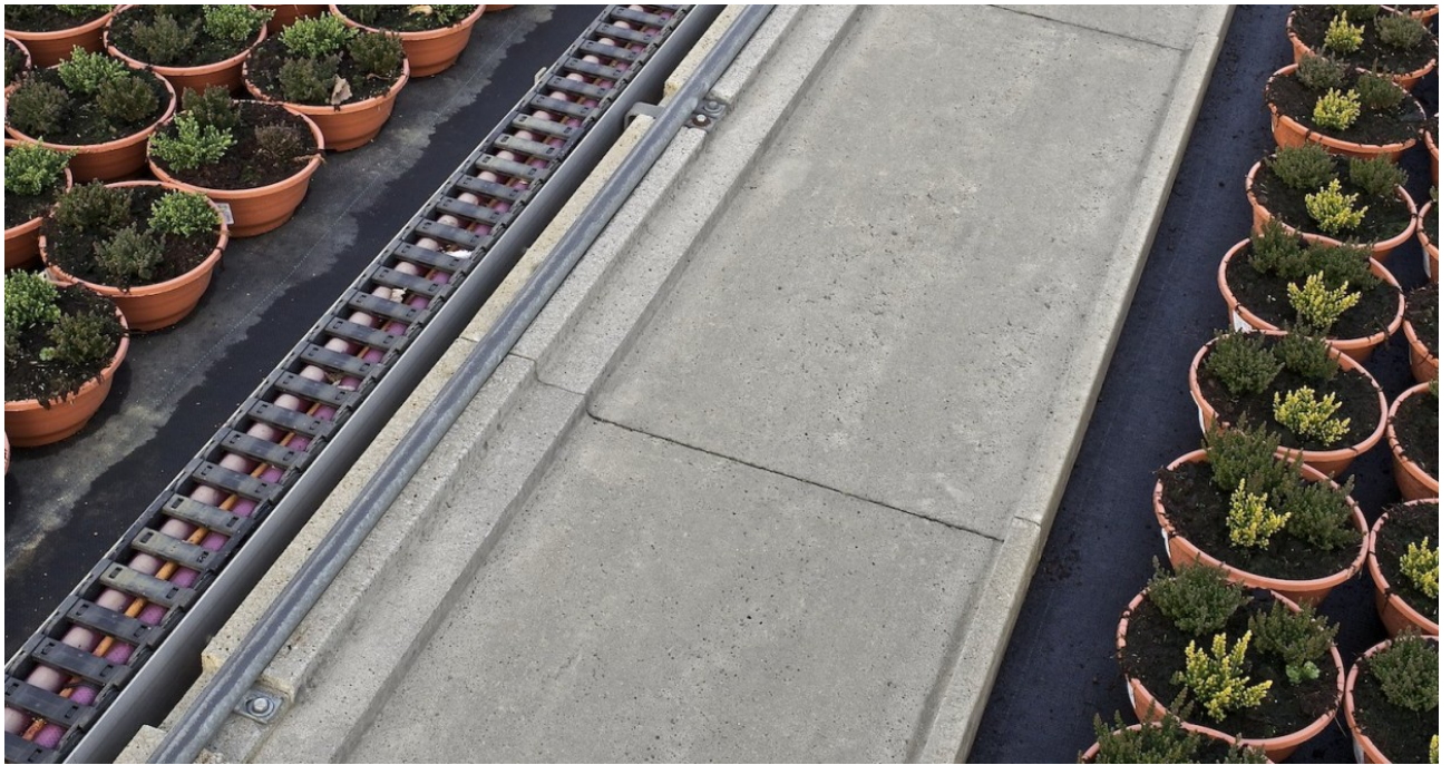
Rys. Nr 9 Polowe ramię zraszające z systemem prowadzenia przewodów w łańcuchu energetycznym
