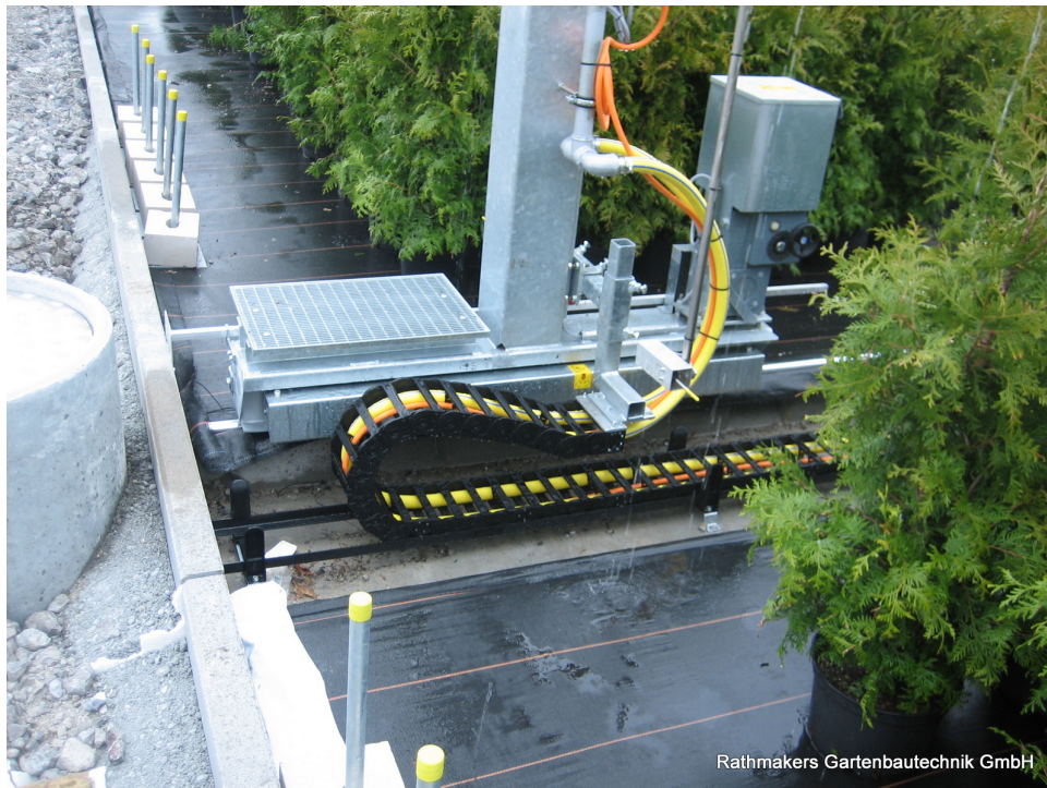
Rys. Nr 8 Polowe ramię zraszające z systemem prowadzenia przewodów w łańcuchu energetycznym
